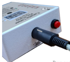
Figura 4. Inserção do conector macho do Cabo Multivias da Caneta Laser Pró-Fono no conector fêmea do Gabinete Plástico.
